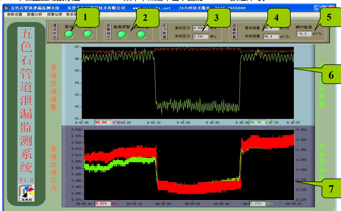
图 6 五色石管道泄漏监测系统界面
